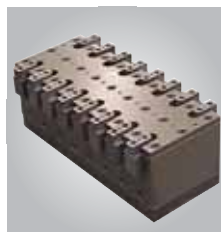
Použitie vyžadovalo uchopovač, ktorý kvôli nedostatku miesta zjednocovalo 8 uchopovačov v jednom bloku
